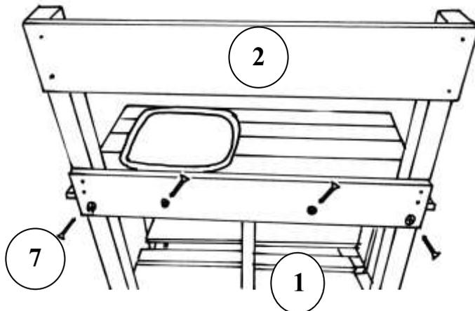
4. Fixieren und sichern Sie das Oberteil an beiden Seiten mit den Schrauben. (8)
